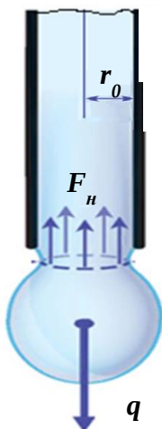
Рис. 5. Схема, описывающая сталагмометрический метод измерения поверхностного натяжения
