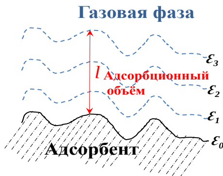
Рис. 23. Схема адсорбционного объёма по представлениям полимолекулярной теории адсорбции Поляни. \varepsilon_0 , \varepsilon_1 , \varepsilon_2 , \varepsilon_3 – эквипотенциальные поверхности (поверхности с одинаковым адсорбционным потенциалом)
