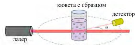
Рис. 14. Схема установки для изучения статического рассеяния света
