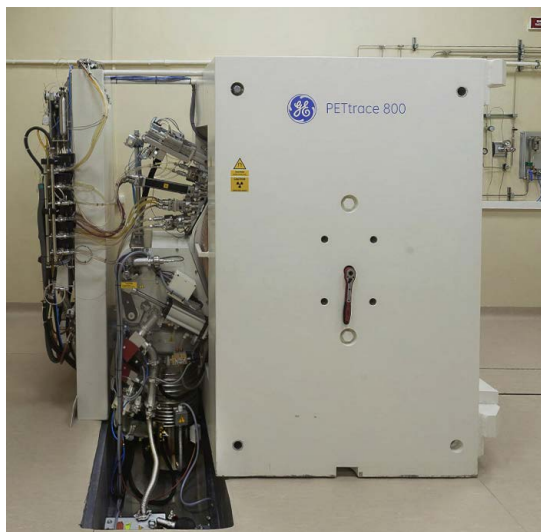
Рис. 50. Циклотрон General Electric PETtrace 880, установленный в ФГБУ «РНЦРХТ имени академика А. М. Гранова» Минздрава РФ, Санкт-Петербург)
