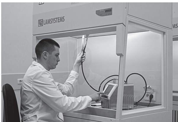
На фото (слева направо): измерение скорости воздушного потока анемометром проверка целостности HEPA фильтра счетчиком аэрозольных частиц визуализация движения потоков воздуха с помощью генерации дыма
